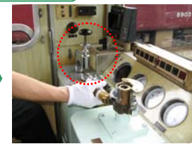
運転台ハンドルのスイッチを離した状態(ブレーキ作動)
