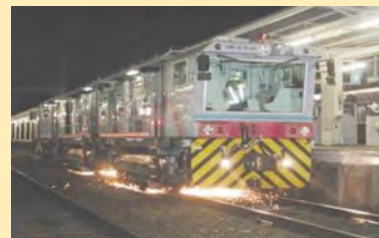
※レール削正車 列車走行に伴う、騒音・振動を低減するため、レール表面の僅かな凸凹、傷等を走行しながら削る車両。
