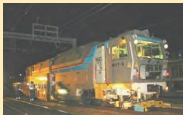
※マルチフルタイトンパー 列車の走行安全性、乗り心地を確保するため、軌道の僅かなゆがみを、走行しながら自動的に矯正する車両。
