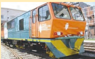
※軌道検測車 軌道の状態について、測定・検査する車両。 3ヶ月ごとに定期的実施。
