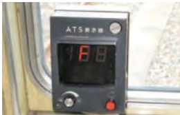
1 運転台ATS車内表示器
