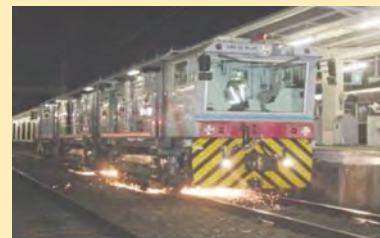
※レール削正車 列車走行に伴う、騒音・振動を低減するため、レール表面の僅かな凸凹、傷等を走行しながら削る車両。
