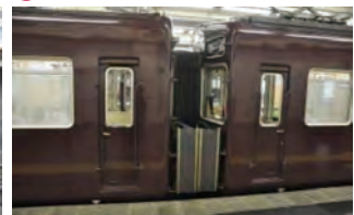
連結面間転落防止装置
