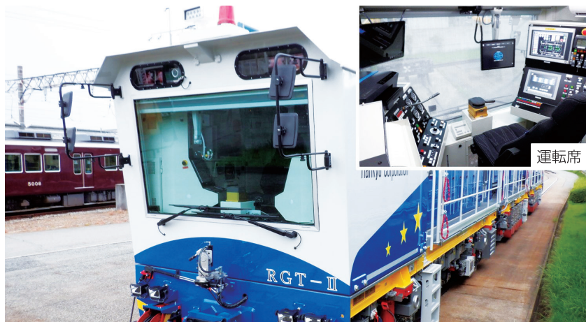
2020年10月に更新したレール削正車
