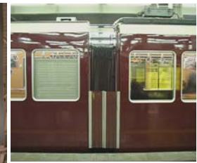
連結面間転落防止装置
